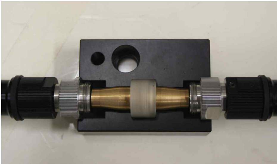
그림 4-5 제작된 Flanged Circular Coaxial Transmission Line Holder
