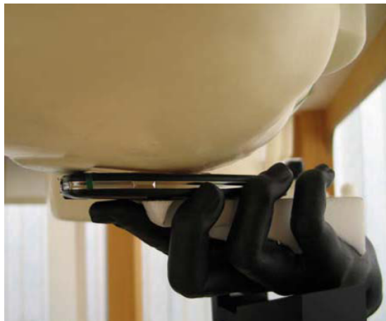
그림 3-20. Hand phantom을 이용하여 SAR를 측정하는 모습
