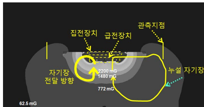
그림 4-29 수직 자속 급/집전장치 (a) 입체도 (b) 정면에서 본 단면도
