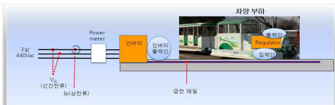
<그림 3-13> 급전 및 집전의 구조도
