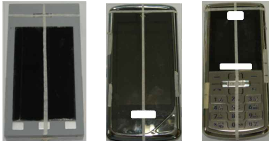
(a) 제작된 휴대전화 (b) 835 MHz (c) 1.765 GHz 대역의 상용 휴대전화 그림 5-31. 시험용 휴대전화
