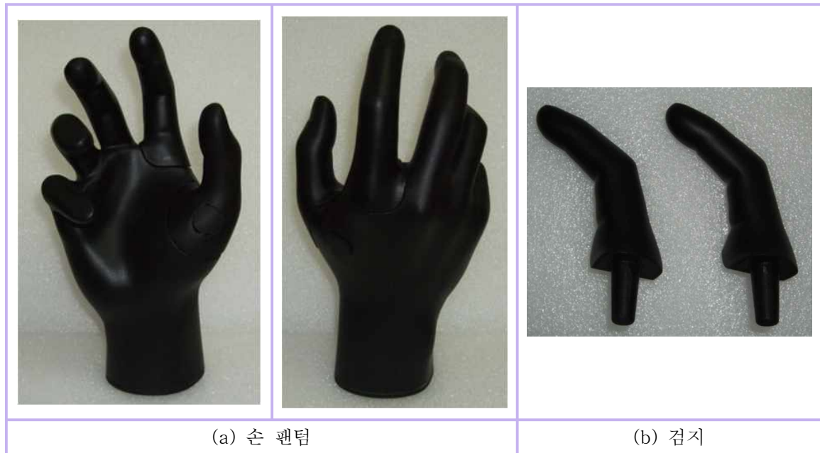
그림 5-28. 제작된 1800 MHz 대역의 손 팬텀 및 검지의 모습
