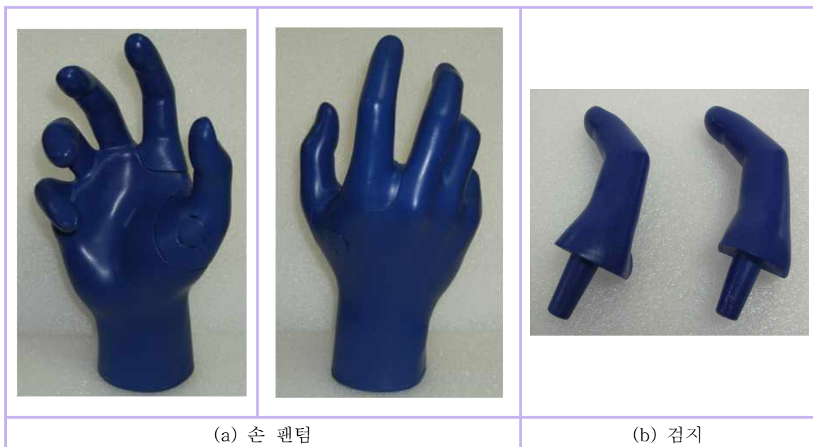
그림 5-27. 제작된 835 MHz 대역의 손 팬텀 및 검지의 모습
