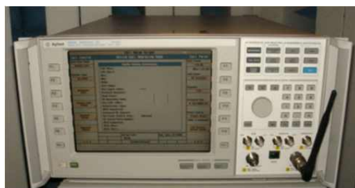
(a) 음성신호를 걸어주는 기능이 있는 기지국 시뮬레이터
