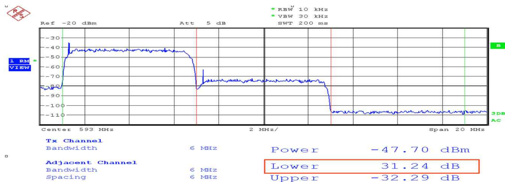
그림 2-1-10 하위 인접 DTV 간섭 측정 결과 파형
