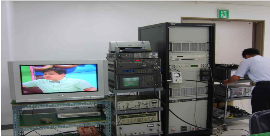
그림 2-1-9 DTV 간섭시험 측정 사진
