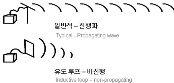
그림 3-30 30 MHz 이하 주파수 안테나에 따른 전파 특성
