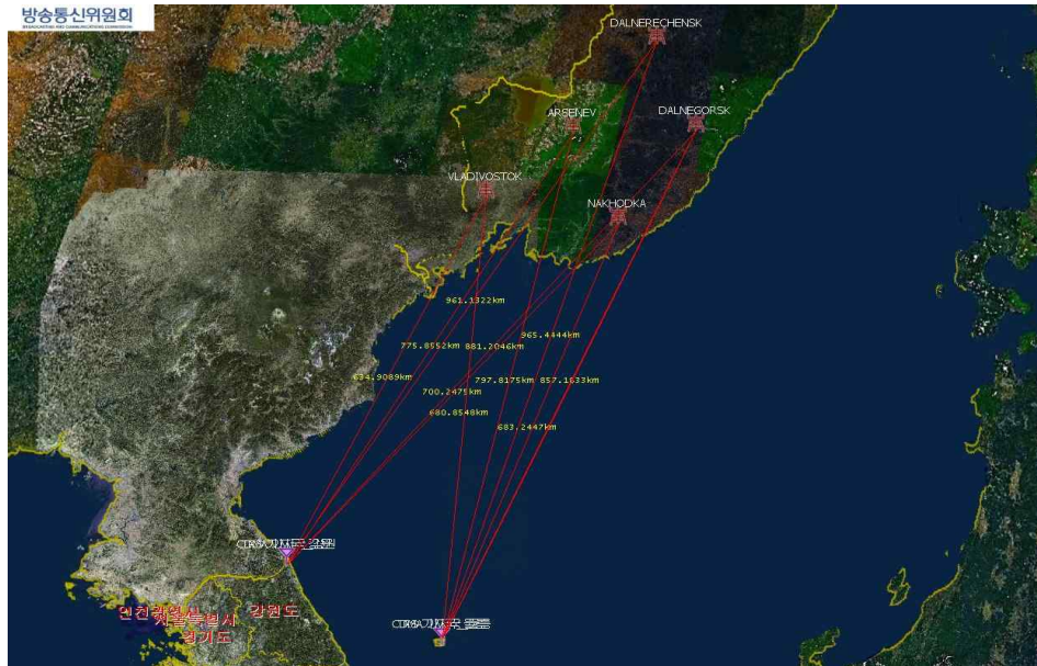
그림 3-17. 러시아 방송국과의 거리 확인 및 간섭국 선정
