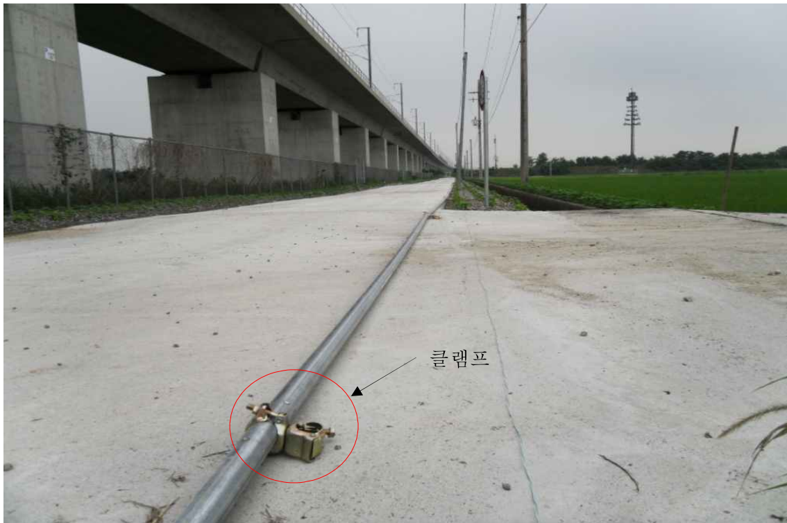
그림 3-9 강관재료 연결 실험 설치 현장(사진)
