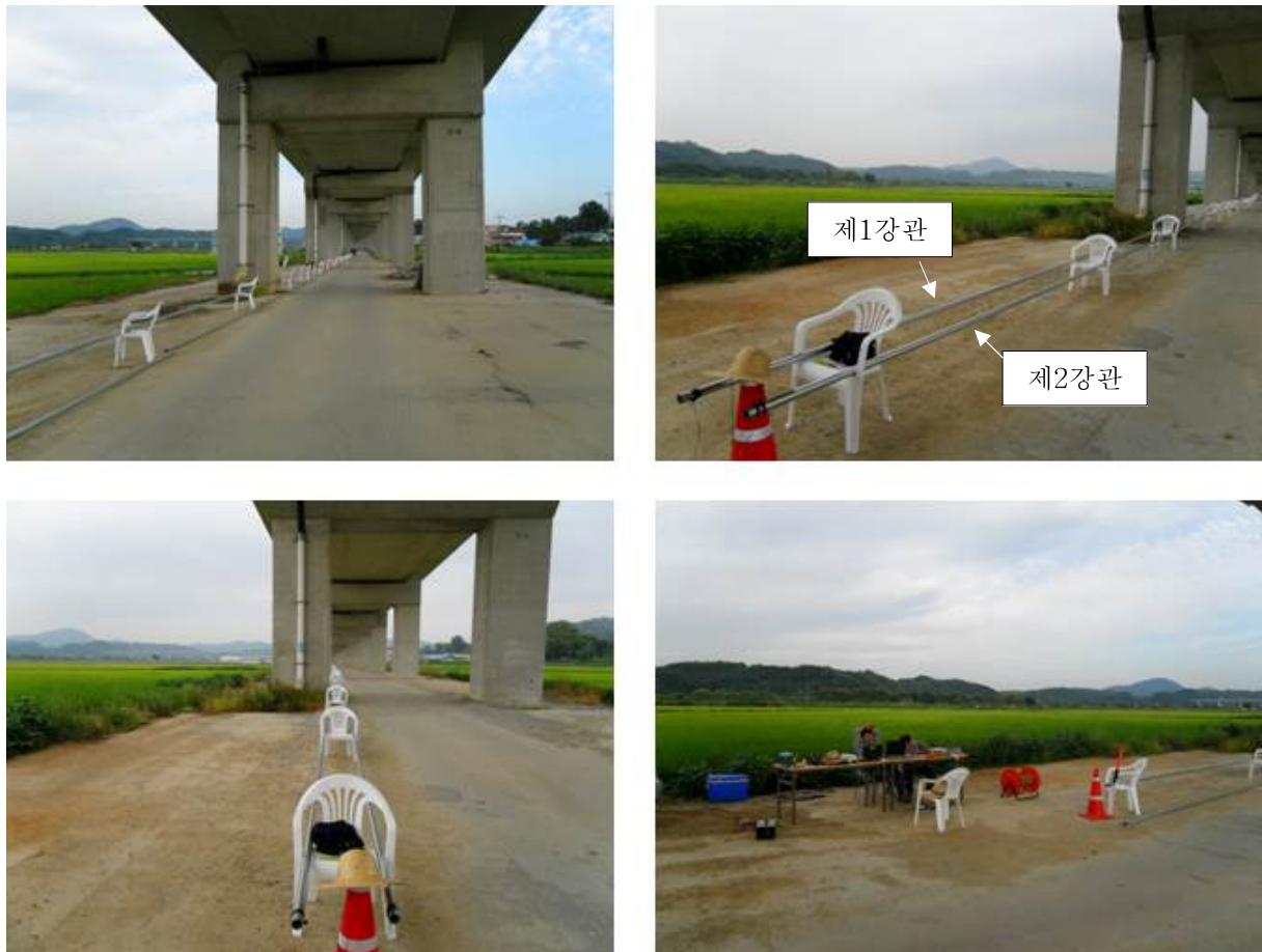
그림 3-11 풍세 현장 실험측정 강관재 포설 사진
