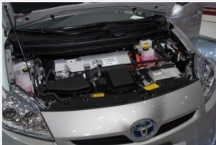
하이브리드는 크게 직렬식, 병렬식, 혼합식 등으로 나뉜다. 사진은 혼합식을 이용한 도요타 하이브리드 시너지 드라이브 엔진
