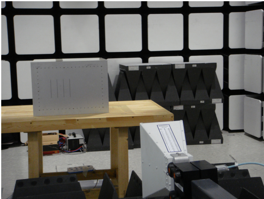
그림 4-1-19 함체 복사 패턴(elevation angle) 측정 셋팅
