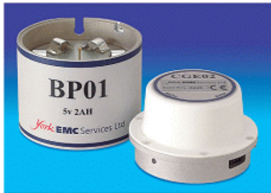
(b) CGE를 안테나와 배터리 팩으로 분리 했을 경우의 모습 그림 4-1-6 측정에 사용된 소스원인 CGE
