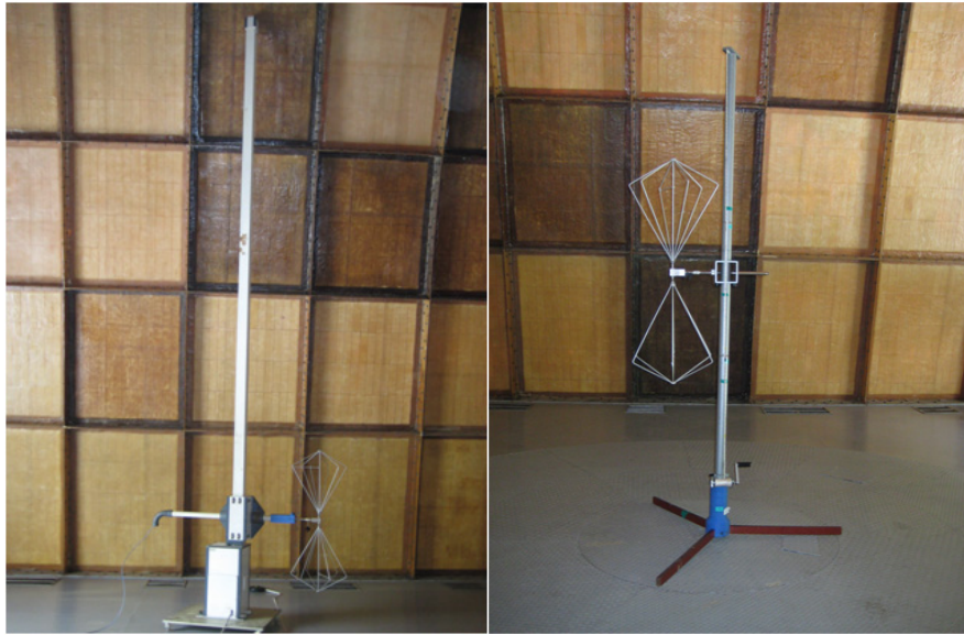
그림 2-7 수신(좌)과 송신(우) 안테나 및 마스트
