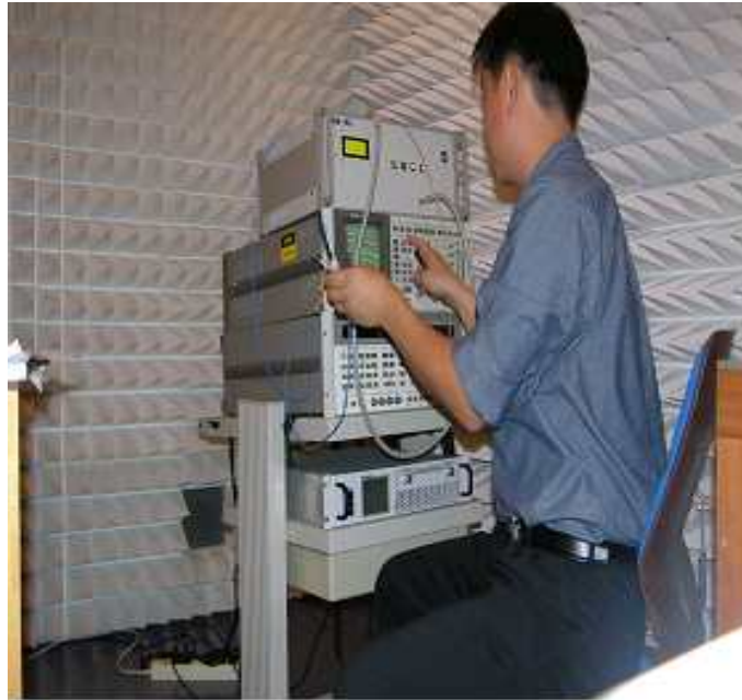
[그림 3-22] 챔버내에서 800 MHz 이동통신 단말기 장애시험
