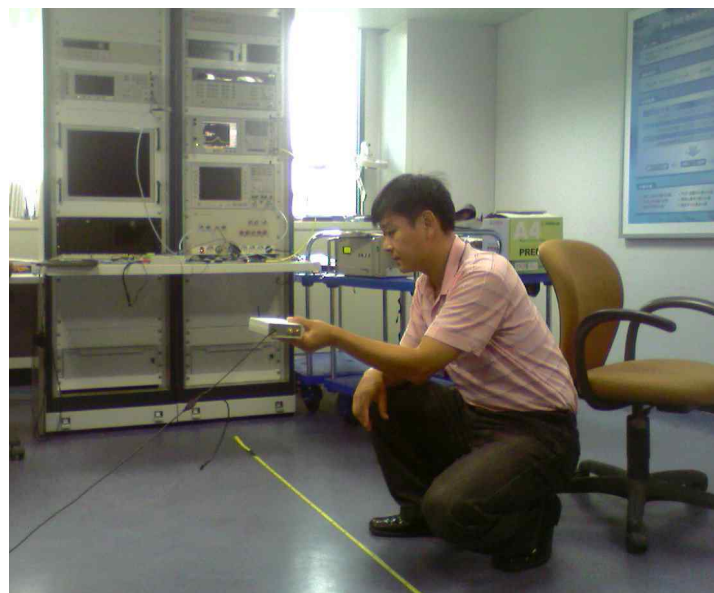
[그림 3-29] 블루투스의 거리별 공간 감쇄량 측정
