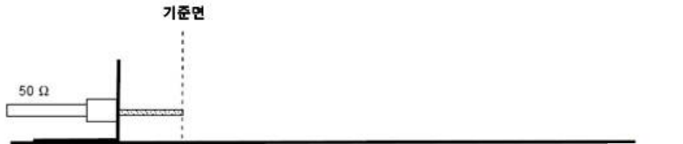
그림 24a-교정 측정 “반사 포트 A”의 구성
