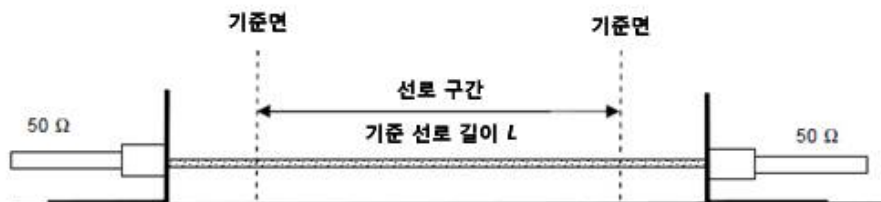
그림 24d-교정 측정 “선로”의 구성
