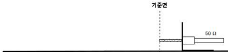
그림 24b-교정 측정 “반사 포트 B”의 구성
