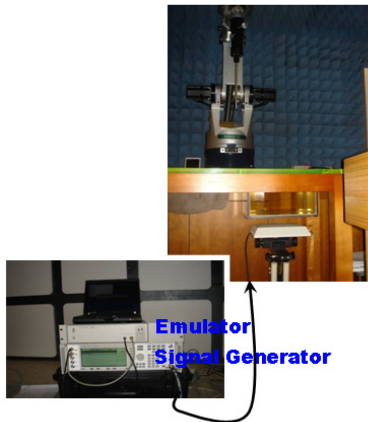
그림 4-36. SAR 측정 set-up
