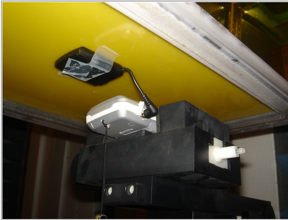
그림 5-5. 2.4 GHz ~ 2.48 GHz 무선데이터통신용(블루투스) 단말기의 SAR 측정
