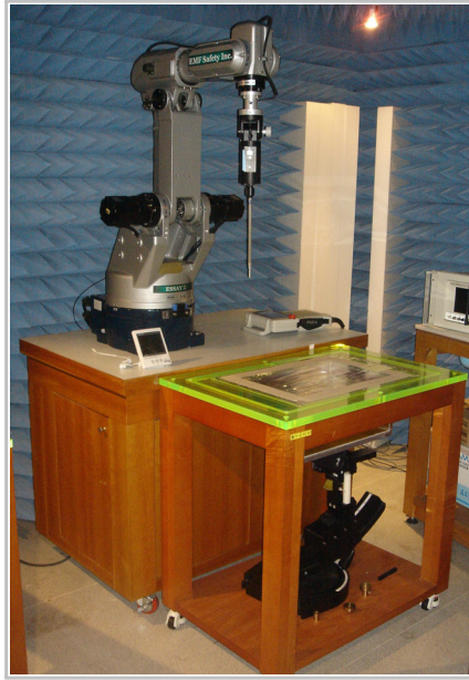
그림 3-3. SAR 측정 시스템
