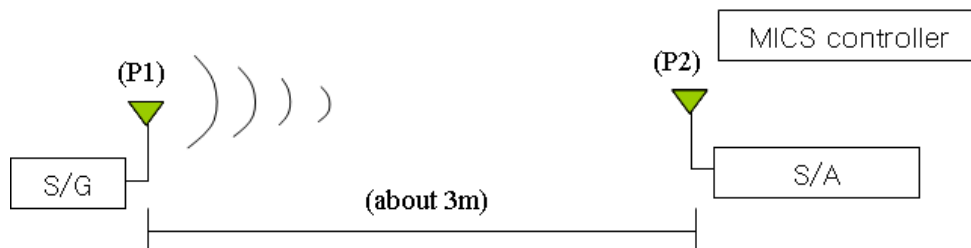
그림 3-2-5 복사방식에 의한 MICS LBT 기술기준 시험구성도
