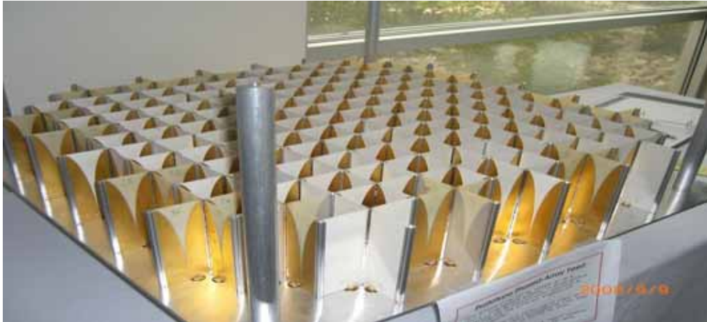
그림 4-1 Multi-phase 전파수신기 제작 과정
