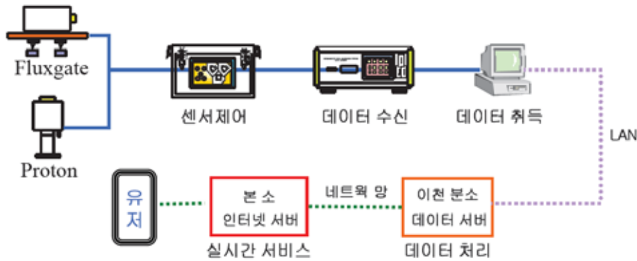
그림 3-12 지자기 관측 시스템 구성도
