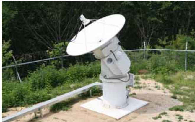
그림 4-12 2.8GHz 태양전파 절대플럭스 관측기
