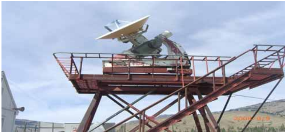
그림 2-1 2.8GHz 태양전파 절대플럭스 관측 시스템. 주 수신안테나
