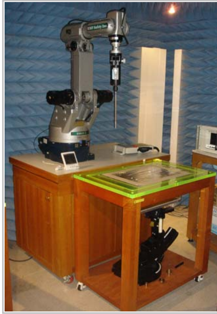
그림 4-3 무전기 SAR 측정 시스템
