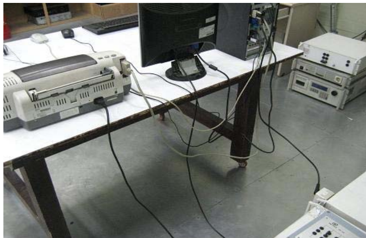
그림 3-5 서지 내성시험 장면
