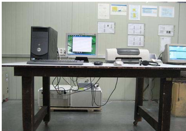
그림 3-7 전압강하 및 순간정전 내성시험 장면
