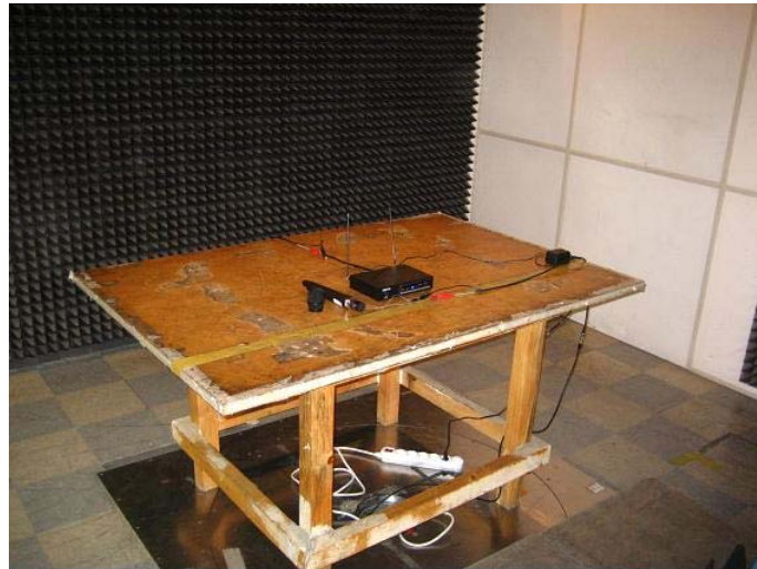
그림 4-5 방사성 RF 전자기장 내성시험 장면
