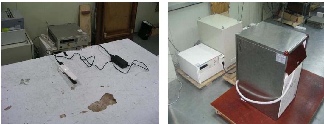
그림 5-2 EFT/버스트 내성시험 장면
