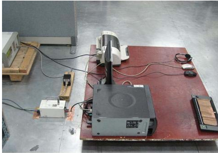
그림 3-6 전도성 RF 전자기장 내성시험 장면
