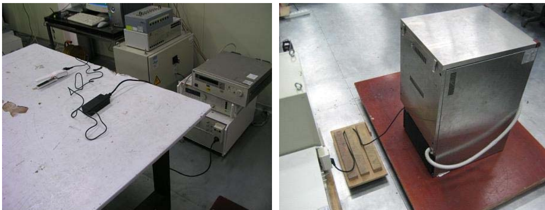
그림 5-4 서지 내성시험 장면
