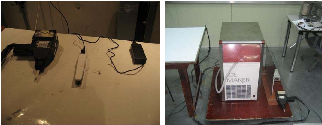
그림 5-1 정전기방전 내성시험 장면
