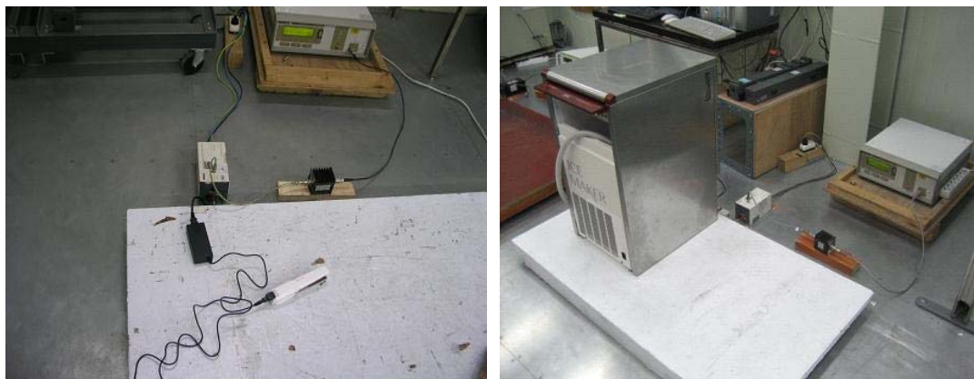
그림 5-3 전도성 RF 전자기장 내성시험 장면
