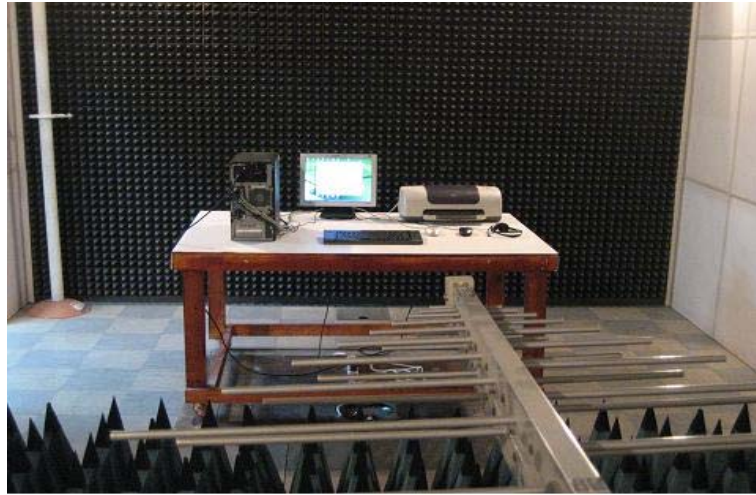
그림 3-3 방사성 RF 전자기장 내성시험 장면
