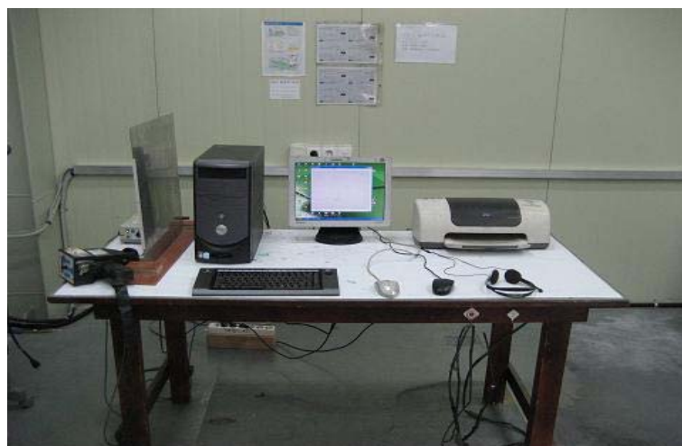
그림 3-2 정전기방전 내성시험 장면
