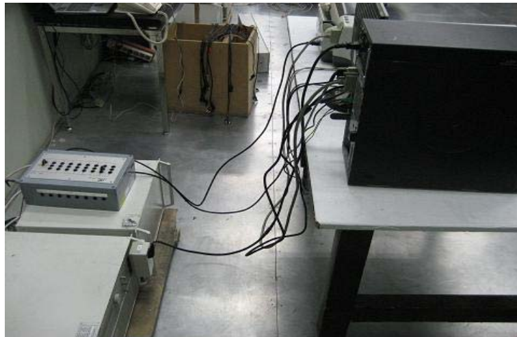
그림 3-4 EFT/버스트 내성시험 장면
