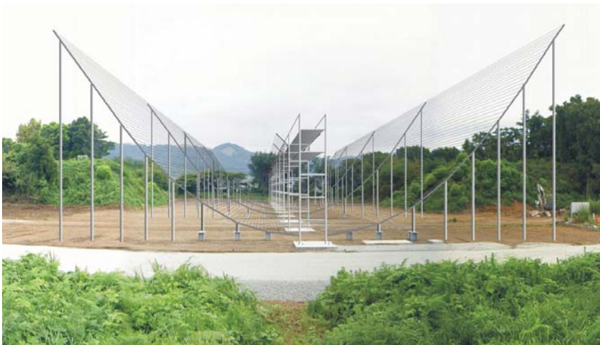
그림 20. 태양풍 관측용 전파망원경. 수신주파수 327MHz, 크기 40mx100m 규모의 태양풍 관측용 전파망원경
