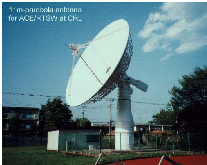
그림 17. ACE위성 자료수신용 포물면. ACE위성에서 실시간 태양풍자료를 수신하는 11m 포물면 안테나
