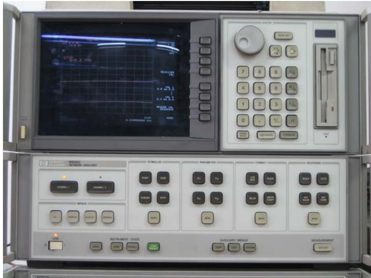
그림 4-3. 네트워크 분석기 (HP 8510C)와 S-parameter 테스트기 (HP 8517B)
