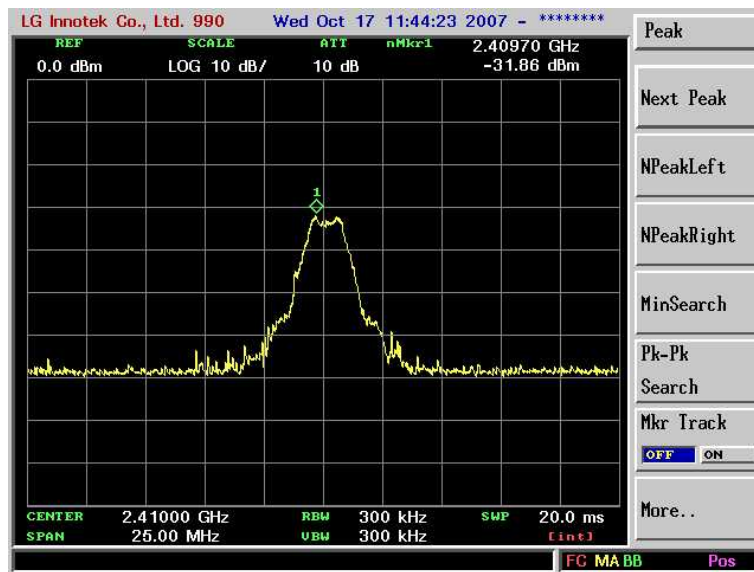
그림 4-24. Fully-anechoic chamber 측정시 XBee Pro의 수직편파 최대 출력
