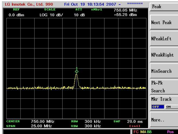
그림 4-7. 실내 환경 측정시 무선 마이크의 수직편파 최대 출력
