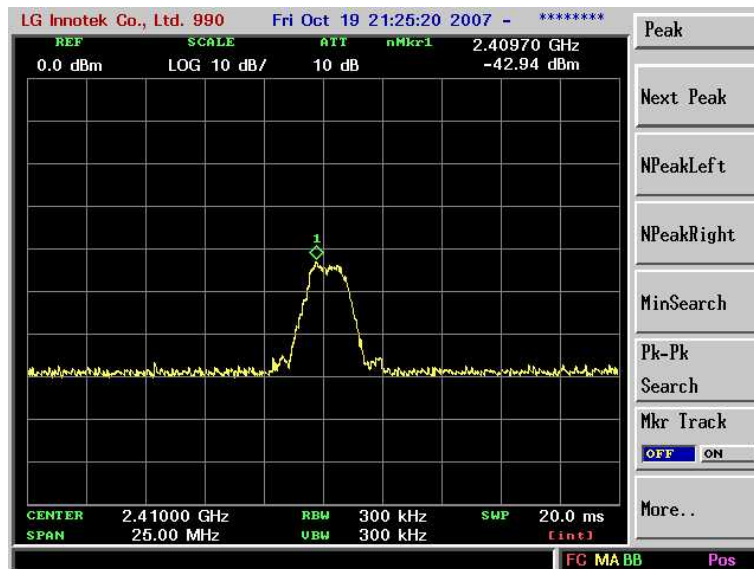
그림 4-15. 실내 환경 측정시 XBee의 수평편파 최대 출력
