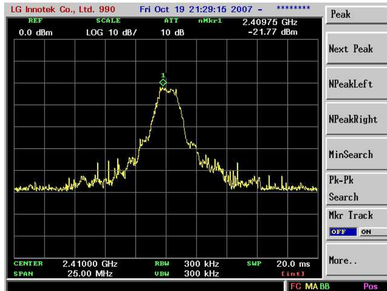
그림 4-21. 실내 환경 측정시 XBee Pro의 수평편파 최대 출력
