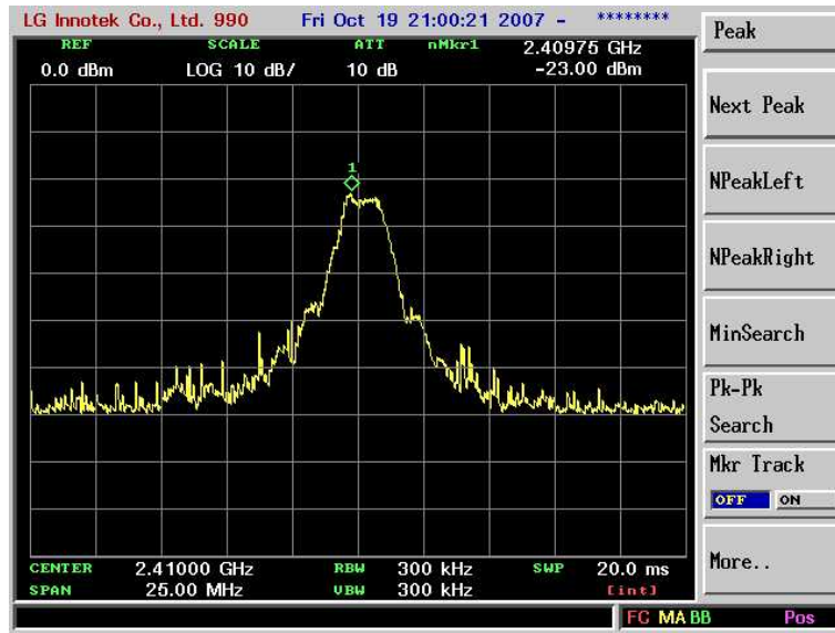
그림 4-20. 실내 환경 측정시 XBee Pro의 수직편파 최대 출력
