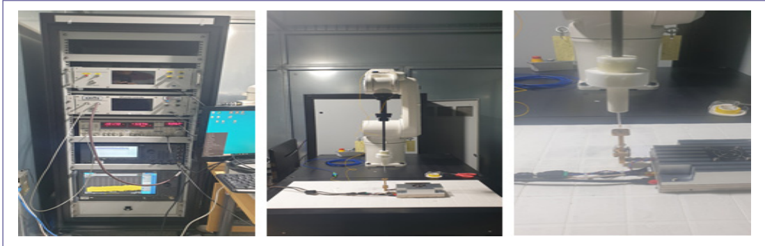
[그림 2-7] 완전유전체 광센서 프로브를 이용한 전력밀도 측정 모습
