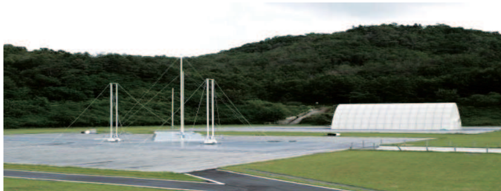
[그림 5-11] 안테나 측정 야외시험장(30m × 60m : 금속판+금속메쉬)
