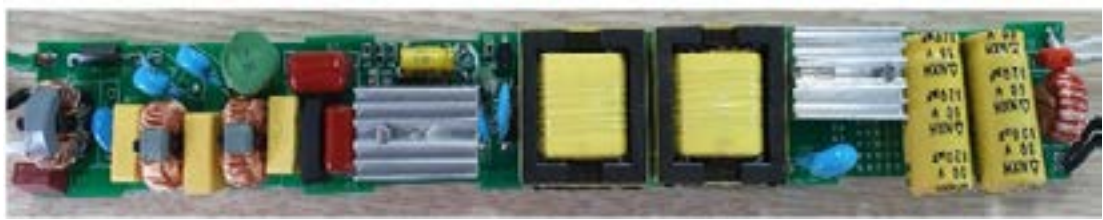
[그림 2-3] EMC 저감기술이 반영된 LED 조명 컨버터 PCB
