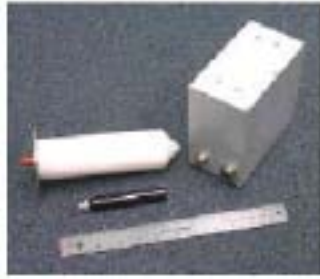
그림 1-11. 정확한 위치를 측정하기 위한 UWB 트랜시버
