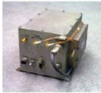
그림 1-6. 비대칭 양방향 링크의 명령과 제어 신호를 전송하기 위한 UWB 트랜시버
