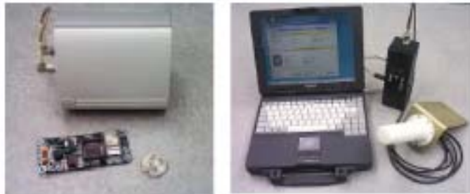
그림 1-8. UWB 태그와 태그 리더 시스템
