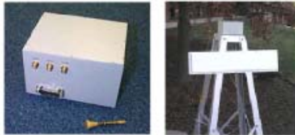
그림 1-12. UWB 기술을 이용한 고도계와 충돌방지 센서
