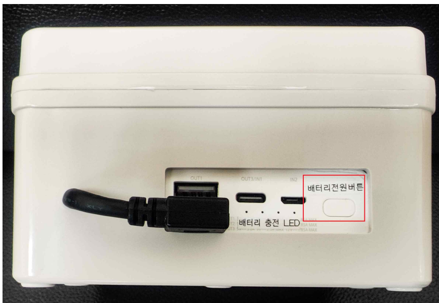
[그림 3] 시험시료 후면 배터리 전원 스위치
