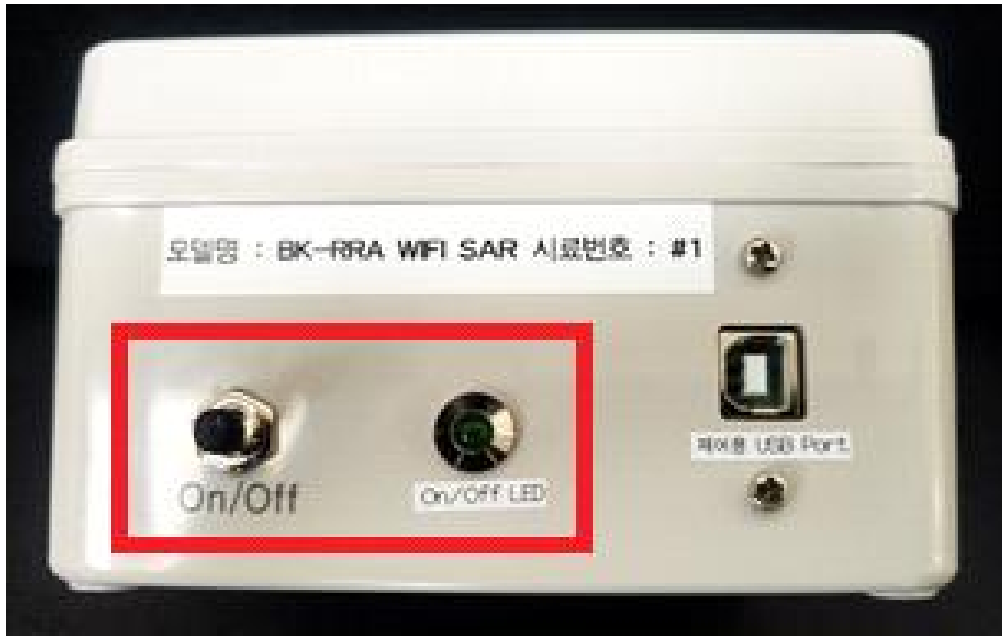
[그림 4] 시험시료 전면 전원 스위치 및 On/Off LED
