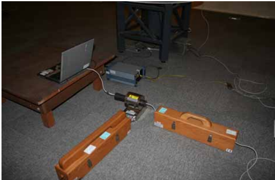
그림 4-5. 전압프로브에 의한 전자파전도시험
