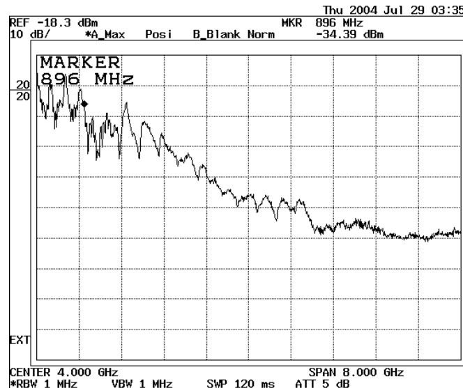
(b) Impulse 방식 UWB 신호 스펙트럼( f_c=1\text{GHz} )
