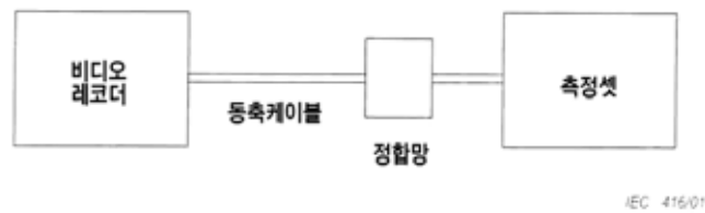
그림.9 비디오 레코더 RF 출력에서의 회망신호와 방해전압 측정회로 배치(5.5.2 참조)
