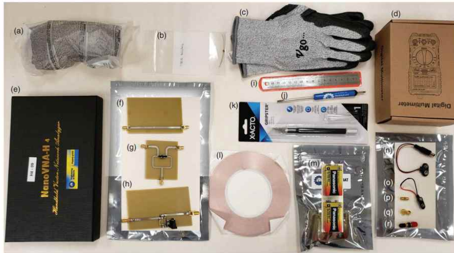
[그림 2-16] 실험실 키트 (a) 보안경, (b) 100\Omega 저항, (c) 핑크 방지 장갑, (d) 디지털 멀티미터, (e) Nano VNA, ((e) Nano VNA, (f) 필터 회로, (g) 윌킨슨 전력분배기 회로, (h) 증폭기 회로, (i) 자, (j) 드라이버, (k) X-ACTO 칼, (l) 구리 테이프 (3mm), (m) 9 V 배터리 2개, (n) 배럴 플러그가 달린 9 V 클립, (o) 단락된 9 V 클립, (p) SMA 직선 어댑터, (q) 50\Omega SMA 부하, (r) 20 dB 감쇠기
