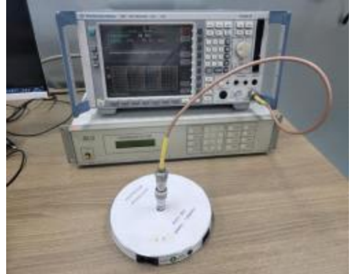
[그림 13] 전자파 차폐실 시험 배치도
