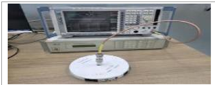
[그림 2] 신호발생기 동작확인을 위한 배치도 및 사진
