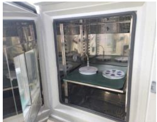
[그림 14] 항온항습 챔버 시험 배치도
