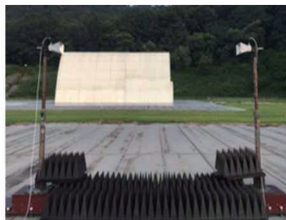
[그림 3.2.1] 자유공간 시험장 평가 측정 구성
