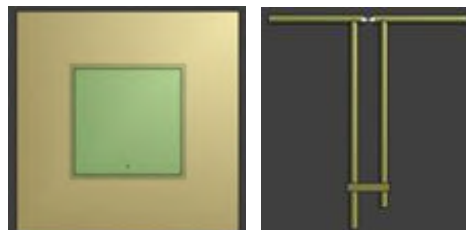
[그림 2-6] 1×4 배열 패치 안테나 및 다이폴 안테나
