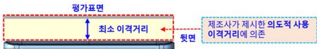
[그림 2-19] 몸통 전력밀도 측정시 평가표면의 이격거리 설정 예시
