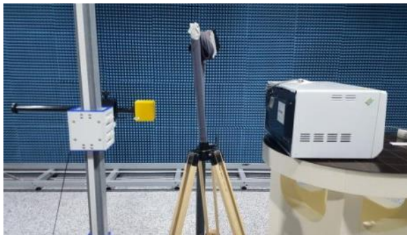
〈60 Hz 전기장 및 자기장 측정〉
