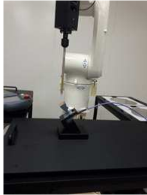
그림 3-9. 28 GHz 3축 전기장 프로브 교정 모습
