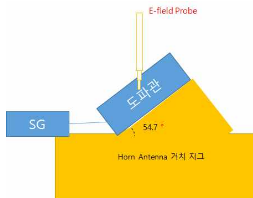
그림 3-7. 6 GHz 이하 SAR 프로브 교정
