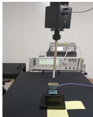
그림 3-12. 28 GHz 단축 프로브 교정 모습
