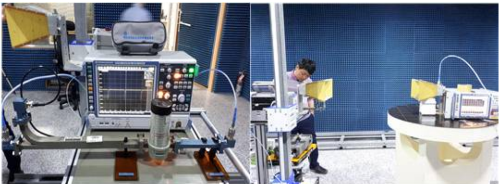
그림 4-6. (좌) Crystal Detector와 오실로스코프가 연결된 X-band 측정시스템. (우) 서로 마주 보고 있는 Tx, Rx 안테나
