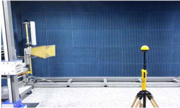
그림 4-9. 9.0 GHz, CW의 신호를 휴대용 전자파 측정기로 측정하는 배치도
