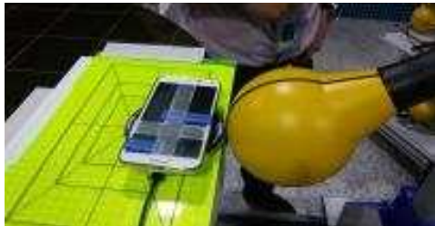
[그림 3-1] 휴대전화 무선충전기의 전자파 측정 구성
