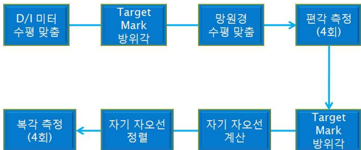
[그림 5-5] 지자기 기준값 측정 방법
