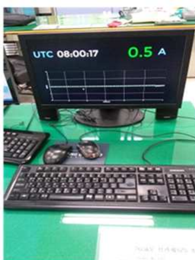
[그림 3-16] 유도전류 상시 모니터링 상황판 설치 및 표출
