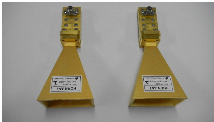
[그림 3-5] 제작된 두 개의 26.5GHz ~ 40GHz대역 혼안테나 쌍
