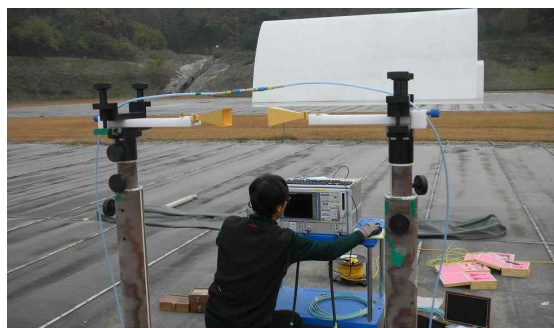
[그림 3-10] 야외시험장에서 안테나 동등성 확인을 위한 감쇠량 측정
