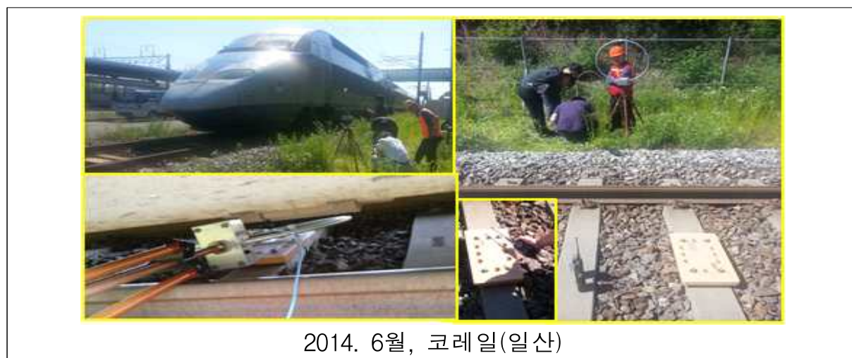
[그림 4-8] 차상장치의 간섭영향실험 구성도와 측정사진
