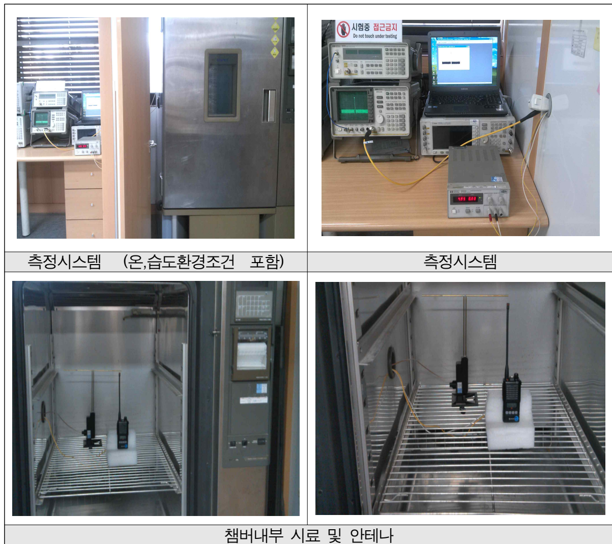
[그림 6-1] 온도 챔버내에서 복사성 측정방법 수행 예(430~470 MHz 휴대용 산업무전기 샘플 이용)
