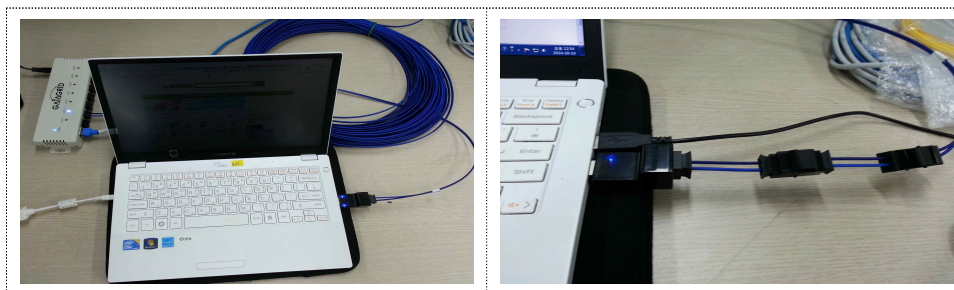
[그림 2-17] POF 케이블 직결 시험 및 어댑터 접속 시험 사진
