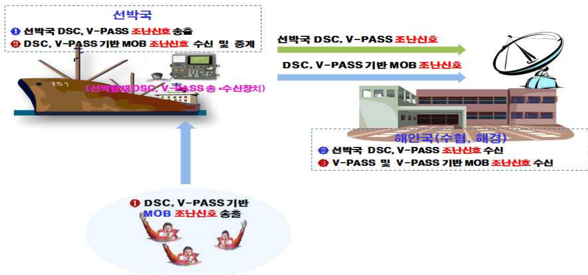
[그림 7] DSC, V-PASS 및 DSC, V-PASS 기반의 MOB 운영 개념도
