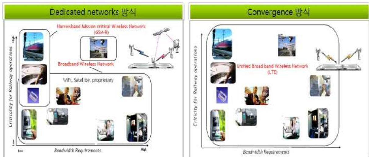
[그림 18] 단계별 LTE-R 통합 구조 방식
