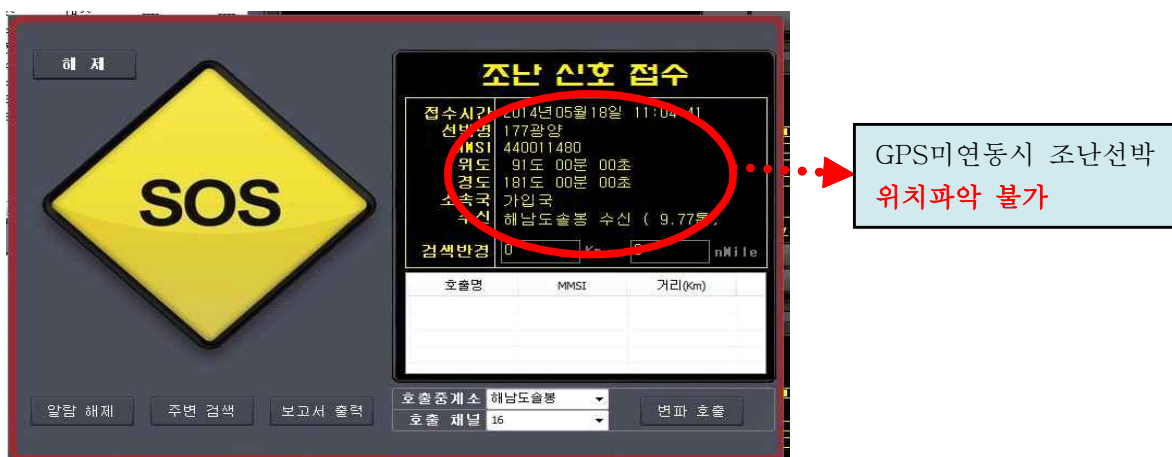
[그림 4] VHF-DSC와 GPS 미연동 상태
